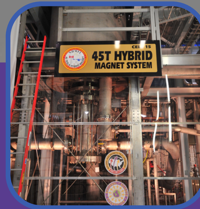
Hybrid 45 tesla 33 MW
